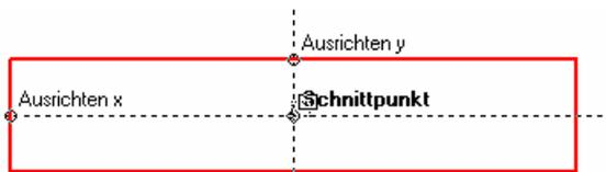
Für den Endpunkt der Verschiebung wählen Sie den Mittelpunkt des Bauteils. Der Mittelpunkt des Bauteils wird automatisch gefunden, wenn Sie den Mauszeiger zuvor über die Mitte der horizontalen und vertikalen Kante ganz aussen am Bauteil bewegen und dann den Schnittpunkt wählen.
