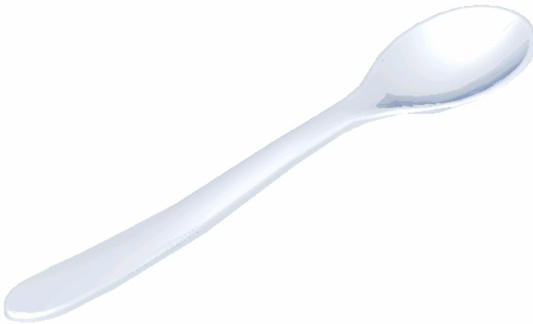
Wenn Sie Änderungen am Teelöffel vornehmen möchten, können Sie dies nach wie vor durch das markieren und verschieben der Kontrollpunkte der B-Splines erreichen. Durch verändern dieser Grundgeometrie wird auch automatisch der Volumenkörper des Teelöffels verändert. Um die B-Spline wieder sichtbar zu machen blenden Sie wieder alle Teile ein. Wählen Sie **Alles zeigen** aus dem **Zeigen-Verbergen** Fenster.
