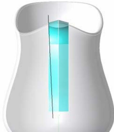
Extrudieren Sie diese Linie mit dem Extrusionsoberfläche (2 Punkte) Werkzeug.
