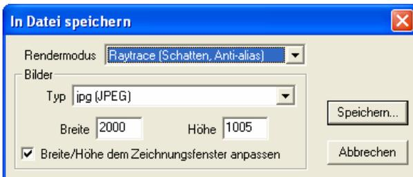
Die Werte in den Feldern **Breite** und **Höhe** bestimmen die Grösse des Rendering in Pixel. Abhängig von der Grösse und der Qualität des endgültigen Renderings muss der Wert angepasst werden. Je höher der Wert ist desto länger dauert die Renderzeit. Beginnen Sie mit einem Wert von 1000 für die Breite und prüfen Sie anschliessend die Qualität am Bildschirm und beim drucken.
